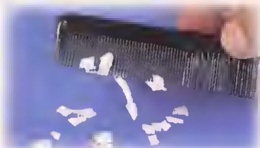
Figura 1.30. Producción de energía eléctrica por fricción
